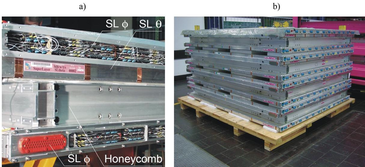
**Abbildung 2.6:** (a) – Eine komplette, mit Elektronik bestückte Aachener Myonkammer [10]. Sie besteht aus zwei  $\phi$ -, einer  $\theta$ -Superlage und dem Abstandshalter. Die obere  $\phi$ -Superlage ist noch nicht mit dem HV-Deckel verschlossen, an der unteren ist für Testzwecke ein HV-Deckel aus Plexiglas angebracht. (b) – Vier fertige und getestete Myonkammern bereit für den Transport zum CERN [11].
