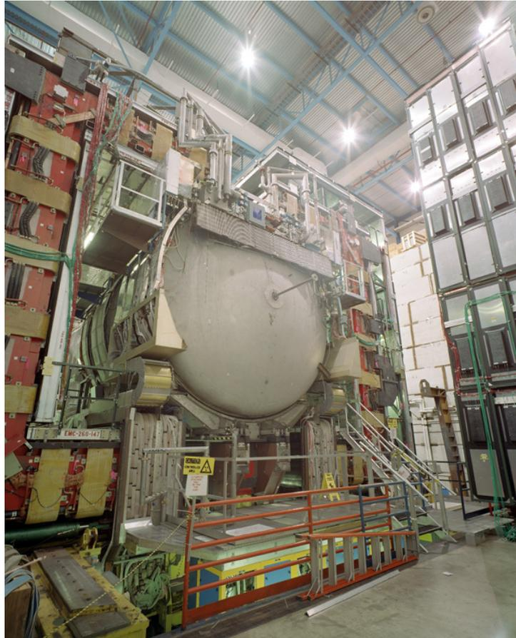
**Abbildung 3.7:** Foto des Kryostaten mit dem zentralen Kalorimeter (links). Neben der Strahlröhre ist hier der Solenoid-Magnet zu erkennen. Während der Einbauphase der zentralen Spurdetektoren wurde der Kryostat mit dem Endkappen-Kalorimeter herausgefahren (rechts) [21].
