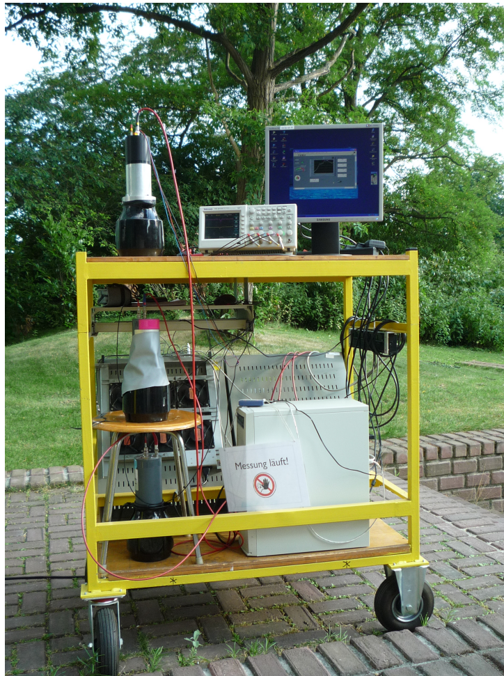
Abbildung 3.23: Der Versuchswagen mit NIM-Crates, Detektoren, PC und Oszilloskop
