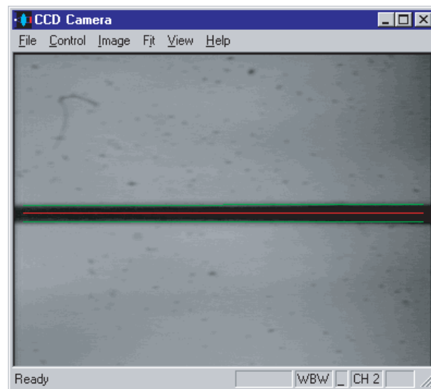
Abbildung 6.18: Bild vom dunklen Draht (vor hell angestrahlten Hintergrund) in der CCD-Kamera. Man sieht zwei grüne Geraden, die an den Rand des Drahtbildes angepasst werden und eine rote Gerade, die an das Zentrum gefittet wird, um die Position des Drahtes zu bestimmen.
