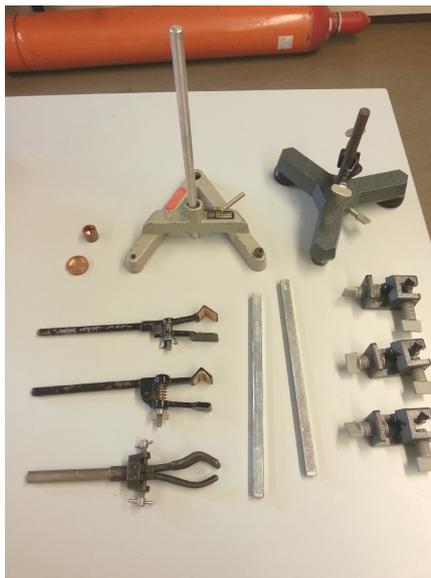
Abbildung 3.1.: Geräte, die für den Versuchsaufbau vorhanden sind. Oben links sieht man die Blenden des Zählrohres und der Quelle. Daneben befinden sich zwei Stative, an denen falls nötig diverse Stangen und Stativklammern mittels der Kreuzmuffen befestigt werden können.
