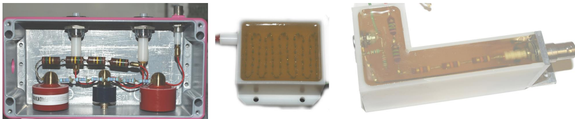
Abbildung 3.5.: Links eine geöffnete und unvergossene Filterbox für die Kathodenhochspannung. Die an den Kammern montierten Metallboxen sind mit Metalldeckel versehen und zur Verbesserung der Spannungsfestigkeit mit einem Silikon gel (Wacker Sil gel) vergossen. In der Mitte ist der Spannungsteiler mit einem Widerstand von 50 \text{ M}\Omega pro Stufe zur Versorgung des Gitters abgebildet. Bei -14 \text{ kV} fließt ein Strom von 24 \mu\text{A} durch den Spannungsteiler. Der Strom der driftenden Ionen innerhalb der Kammer ist sehr viel geringer. Rechts ist der HV-Anoden-Filter zur Spannungsversorgung der Anode gezeigt. Die links in der Seite eingelassene Buchse dient zur Einspeisung eines Testpulses.
