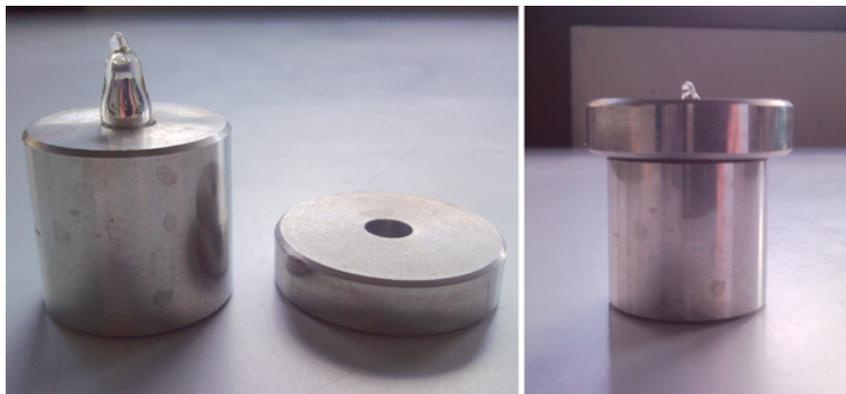
Abbildung 4.2.: Aufbrechhilfe mit Kaliumampulle
