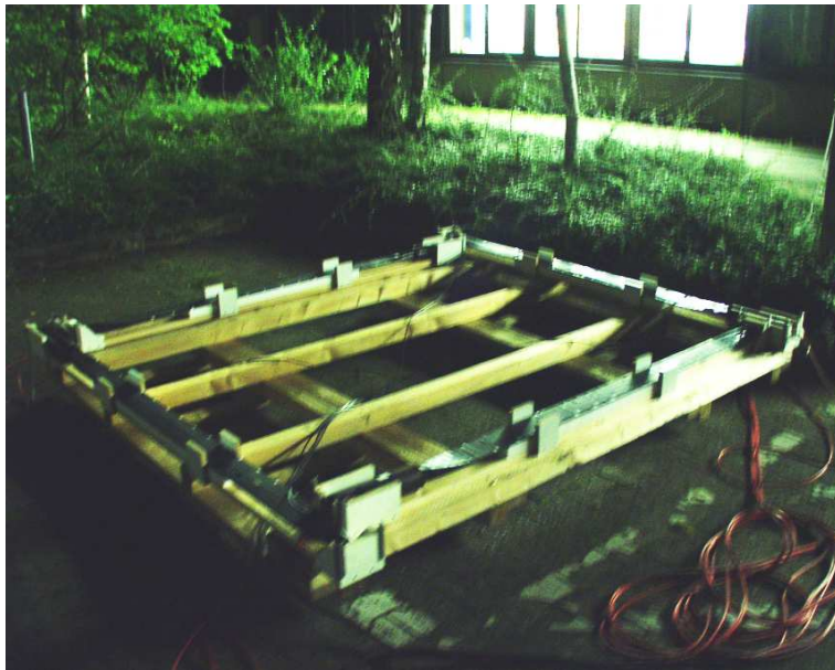
Abbildung 4.20: Aufbau des Luftschauerdetektors auf dem Parkplatz des Physikalischen Institutes. Zu sehen sind die vier Szintillatoren in ihren Holzhalterungen auf der Palette, die die stabile Unterlage bildet. Im Vordergrund liegt ein Ausschnitt der roten Hochspannungskabel, die in die Labore der Werkstatthalle führen (im Hintergrund hell zu erkennen).
