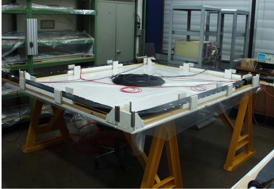
Abbildung 4.1: Aufbau des Luftschauerdetektors im Labor. Im Vordergrund auf dem Tisch die Szintillatoren in ihren Halterungen. Jeweils ein rotes Hochspannungskabel und ein schwarzes Signalkabel führen zu den Versorgungs- und Verarbeitungs-Crates.
