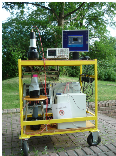
Abbildung 4.20: Der Versuchswagen mit NIM-Crates, Detektoren, PC und Oszilloskop
