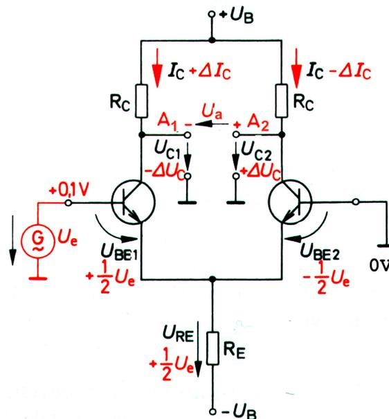
a) Simulieren Sie diese Schaltung mit PSpice für kleine Eingangsspannungen  $U_e \sim \pm 0.01 \text{ V}$  und verifizieren Sie die in der Zeichnung angedeuteten Spannungsänderungen. Wählen Sie  $R_E = 1 \text{ k}\Omega$  und  $R_C = 100 \Omega$  und als Transistoren BC 548B. Beachten Sie wieder die Verwendung zweier Spannungsquellen (4.5 V).
