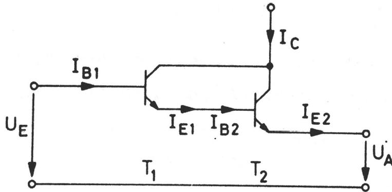
Nehmen Sie die beiden Transistoren BC 548 C. An den Ausgang ( $U_A$ ) schließen Sie bitte einen Lastwiderstand  $R_L = 100 \Omega$  an. Wählen Sie als Spannungsquelle eine  $4.5 \text{ V}$ -Batterie, deren Pluspol mit den Kollektoren der Transistoren verbunden wird.
