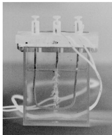
Beim Anlegen einer Spannung zwischen den beiden Elektroden der Apparatur beobachtet man eine Bleiabscheidung. Beim Umpolen der Spannung bildet sich die Abscheidung zurück und bildet sich an der anderen Elektrode neu.
